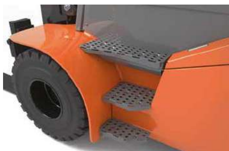
Estribos, peldaños acceso
